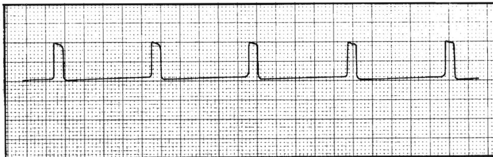
Fig. 3 - Esempi di impulsi di taratura di un elettrocardiografo.
